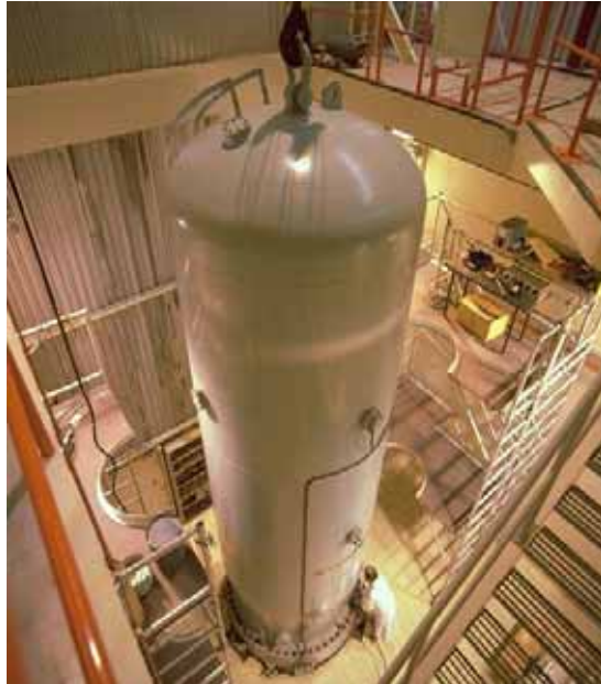
Fig. 2. Van de Graaff accelerator
