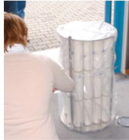
Les cartouches filtrantes qui capturent les particules jusqu'à un micron. La filtration est de 160 m<sup>3</sup>/h.
