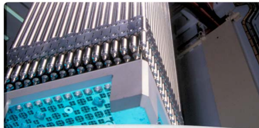
Les combustibles utilisés dans les réacteurs nucléaires sont constitués d'un assemblage de 264 "craquets". Il s'agit de tubes d'environ 4 m de longueur dans lesquels sont emplies des pastilles d'uranium, parfois associées à du plutonium dans certains réacteurs.
